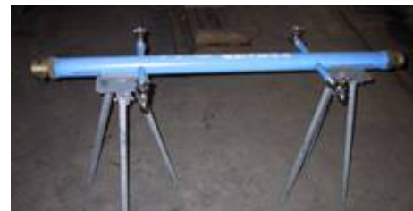
資器材（応急給水栓）
