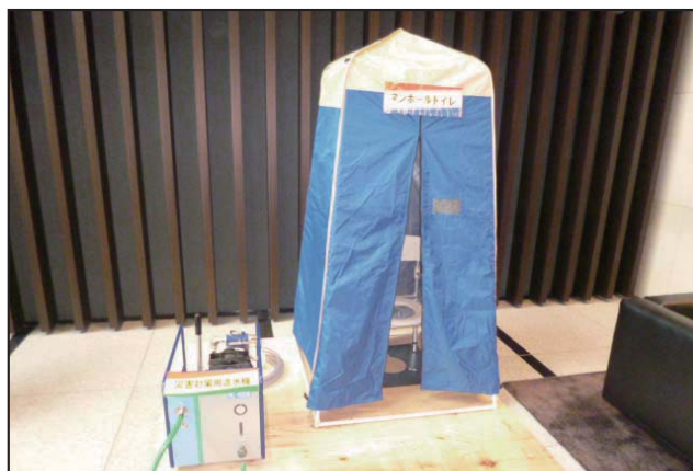
マンホールトイレと災害対策用造水機
