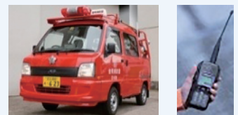
可搬ポンプ積載車
