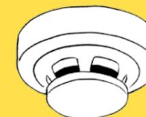
寝室や台所などの天井に設置し、火災により発生する煙や熱を感知し、音や声により警報を発して火災の発生を知らせ、逃げ遅れを防ぎます。いざというときに警報器がきちんと動くように、電池切れに注意し、定期的に点検ボタンを押して、作動確認をしましょう。
