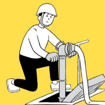
パイプを放口に結合。スピンドルドライバーを回して出水確認後、パイプに結合したホースを延長します。
