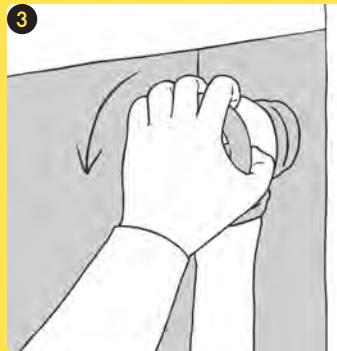
もうひとりが開閉バルブを開きます。火元に向けて放水します。
