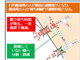
図 待ち時間が徒歩による避難時間となる場合の概念図（自動車一般道も同様の考え方）
