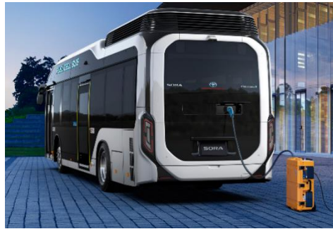
燃料電池バスと外部給電器の接続
