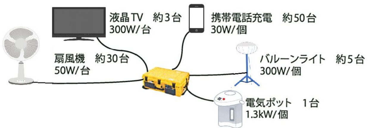
外部給電器と家電製品との接続イメージ（約7kW相当）
