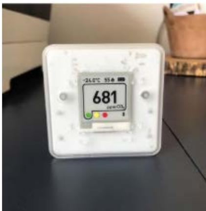
室内CO<sub>2</sub>濃度を建築物衛生法（ビル管理法）の管理基準値1000ppmを満たすための必要換気量は30m<sup>3</sup>/(h・人)になる
