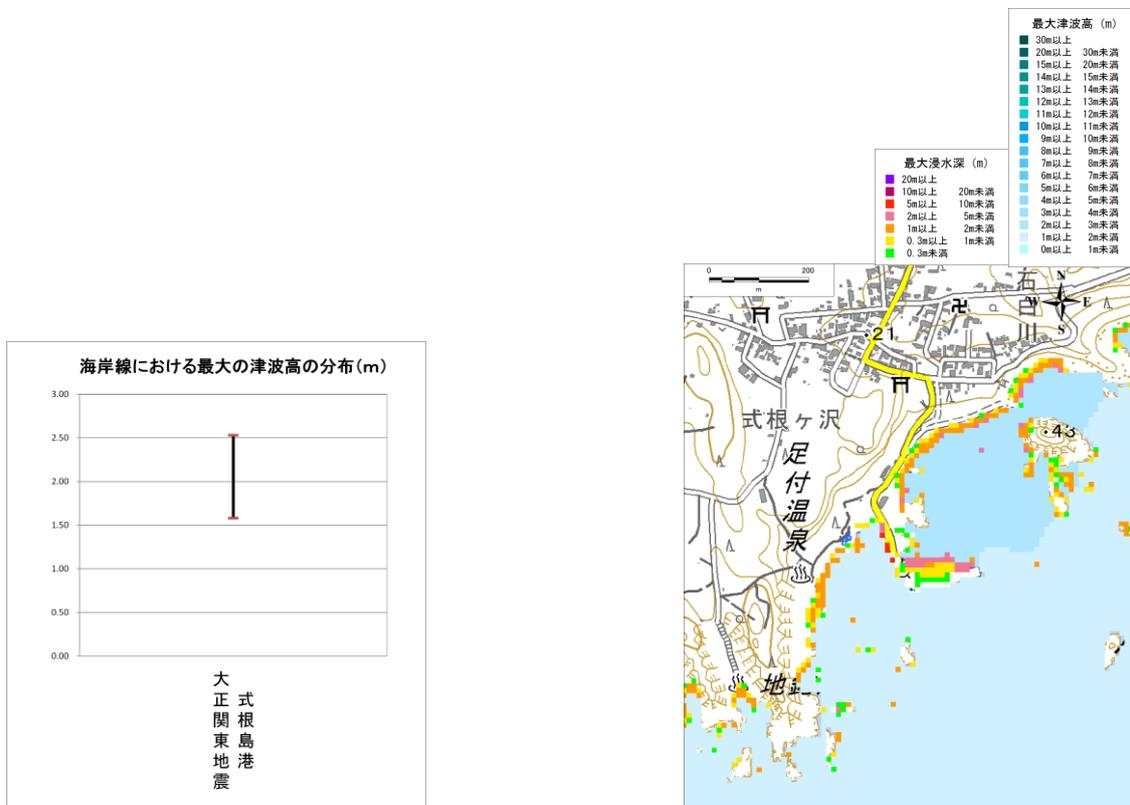
図 大正関東地震の海岸線における最大津波高分布(左図)と
