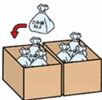
簡易水のうと段ボール箱の併用
