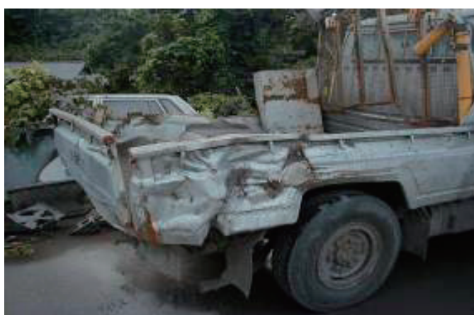
泥流に飲まれ破損した工事車両
