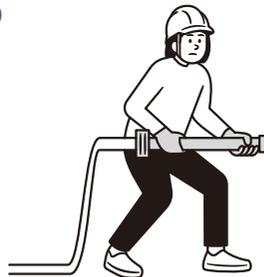
将消防水带拉直，发出信号开始放水。消防水枪对准目标，水枪的位置保持在腰部附近。
