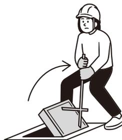
消防竖管在消防车无法进入的狭窄小巷中极为有效。首先插入消防栓扳手，弯腰降低重心打开盖子。
