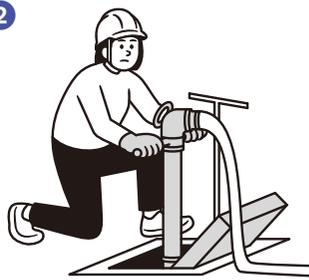
连接竖管与出水口。转动主轴传动机构确认出水后，将连接在竖管上的消防水带展开。
