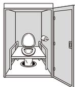
像普通厕所一样使用，将卫生纸直接扔进窨井里。排泄物直接流入下水道。
