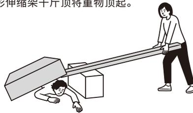
在坚固、平坦的场所使用千斤顶，在千斤顶撑起的空间里支起一块夹板或其他物体，这样即使千斤顶脱落，重物也不会落下。
