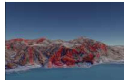
斜面崩落・堆積分布を表示
