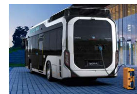
燃料電池バスと 外部給電器の接続
