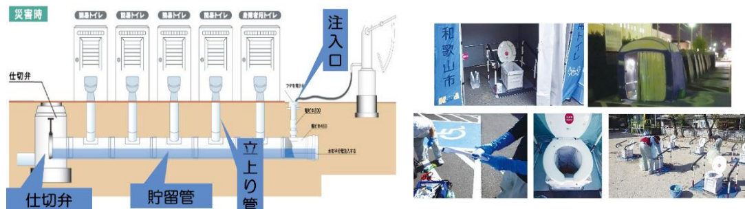
図-22 マンホールトイレの構造及び令和3年10月の大規模断水時の使用事例
