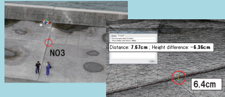
3次元モデル上の計測イメージ (出典: パシフィックコンサルタンツ社内研究資料)
